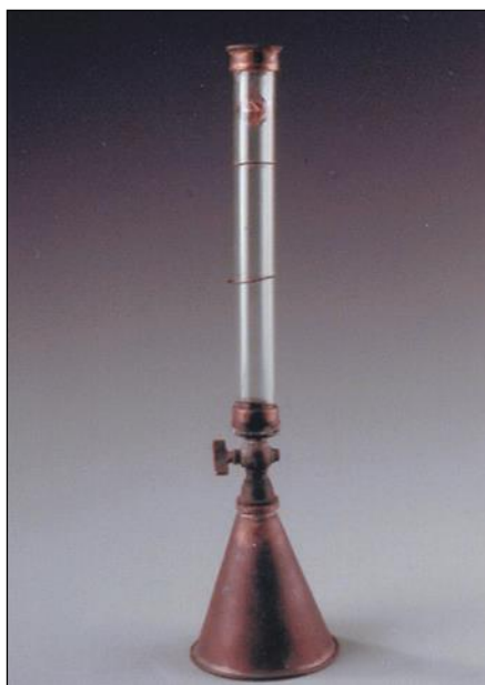
Figura 2 - Eudiômetro de Alessandro Volta: Instrumento para medir a quantidade de oxigênio no ar através da sua reação com o hidrogênio usando uma faísca.
