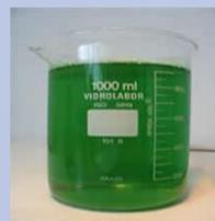
Utilizado para medição de volumes, que não requerem precisão. A presença de um bico facilita a transferência de líquidos. Essa vidraria é de uso geral, útil para realizar misturas e dissolver substâncias durante o preparo de soluções.
