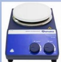
É utilizado para aquecer e agitar soluções, através de campo magnético que fixa o peixinho no fundo do recipiente que contém a solução a ser agitada. Alguns equipamentos possuem aquecimento na placa agitadora, aquecendo e misturando a solução ao mesmo tempo.
