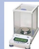
É usada para se obter massas com alta exatidão. Balanças semi-analíticas são também usadas para medidas nas quais a necessidade de resultados confiáveis não é crítica.
