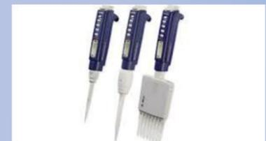
São instrumentos de laboratório utilizados na manipulação e transferência de líquidos. As micropipetas se dividem em dois modelos, monocal e multicanal (8 ou 12 canais). No caso das micropipetas multicanal elas sempre serão de volume variável e o modelo monocal pode ser de volume fixo ou variável.
