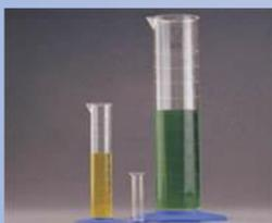
Utilizada para medição e transferência de volumes de líquidos ou soluções com menor precisão que as pipetas. Seu tubo de vidro cilíndrico possui graduação para marcação do volume que ela comporta. Podem ser de vidro ou plástico.
