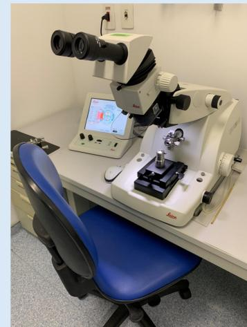
**Figura 3. Ultramicrotomo.** Aparelho onde a amostra em resina epon é lapidada para que os cortes ultrafinos (também feitos pelo equipamento) contemham a amostra, e com a resina Epon bem podada, técnica denominada "Trimagem".
