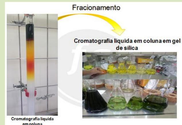
Fig. 5 –Cromatografia Líquida em coluna de gel de sílica
